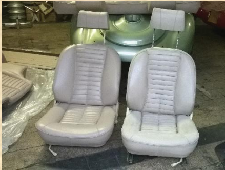
∞ Ανακατασκευή εμπρόσθιων καθισμάτων μίας Maserati Kalamī: Αριστερά, όπως ήταν πριν και δεξιά, όπως έγιναν μετά της περιποίησης.
