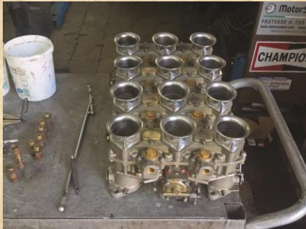
∞ Αποσυναρμολόγηση και καθαρισμός των καρμπυρατέρ μιας Lamborghini Miura του 1967.
