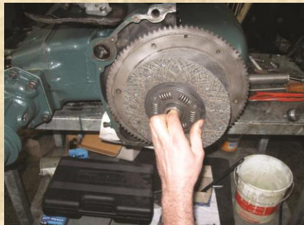
∞Συναρμολόγηση του συμπλέκτη μιας Citroen Traction Avant του 1953.
